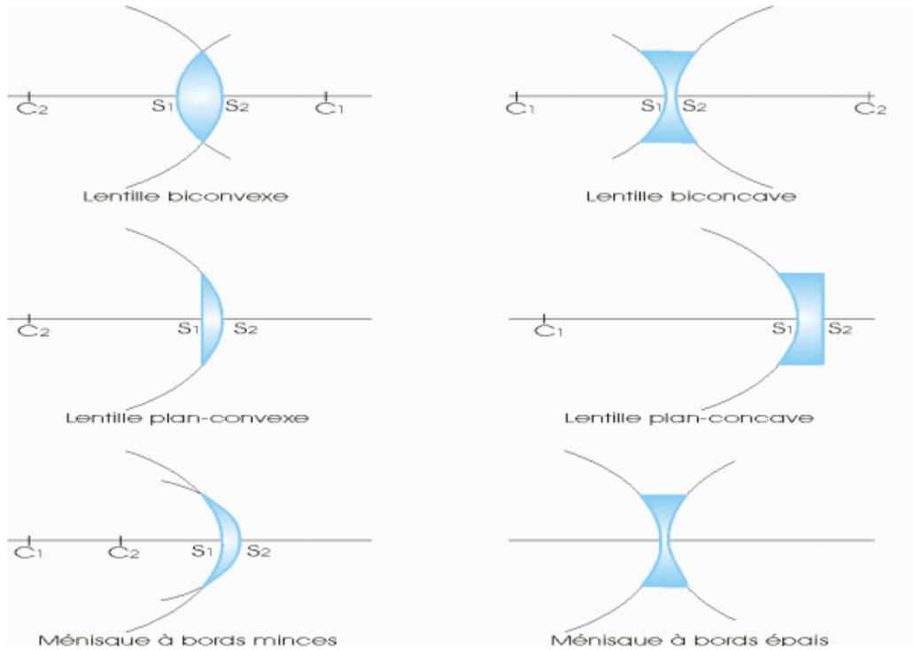
**FIGURE 1.12:** *Différents type de lentilles*
