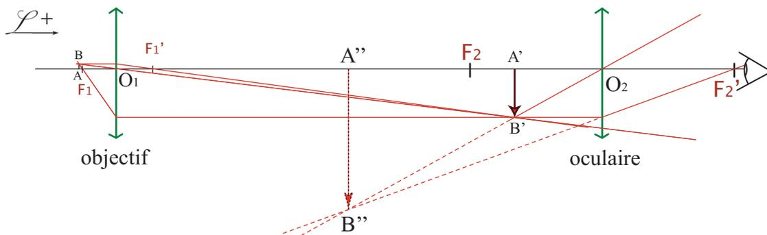
**FIGURE 1.17:** *Principe de fonctionnement du microscope optique*
