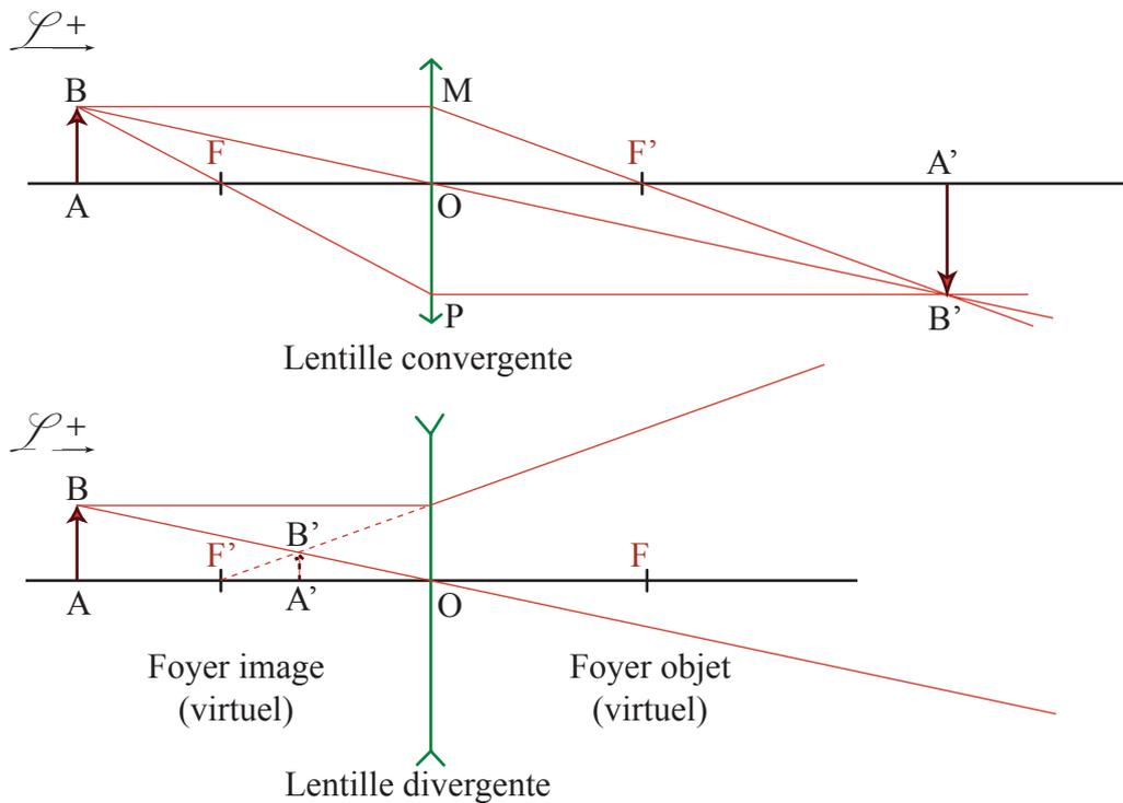
FIGURE 1.14: *Chemin optique à travers une lentille convergente et divergente*
