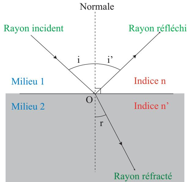
**FIGURE 1.5 :** Définition des angles d'incidence ( $i$ ), de réfraction ( $r$ ) et de réflexion ( $i'$ ) et des rayons correspondants dans le plan d'incidence
