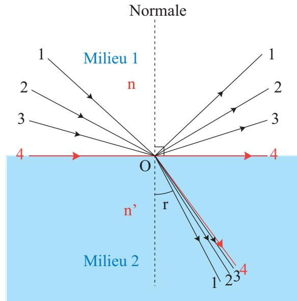
**FIGURE 1.6:** Evolution de l'angle incident  $i$  et de l'angle réfracté  $r$
