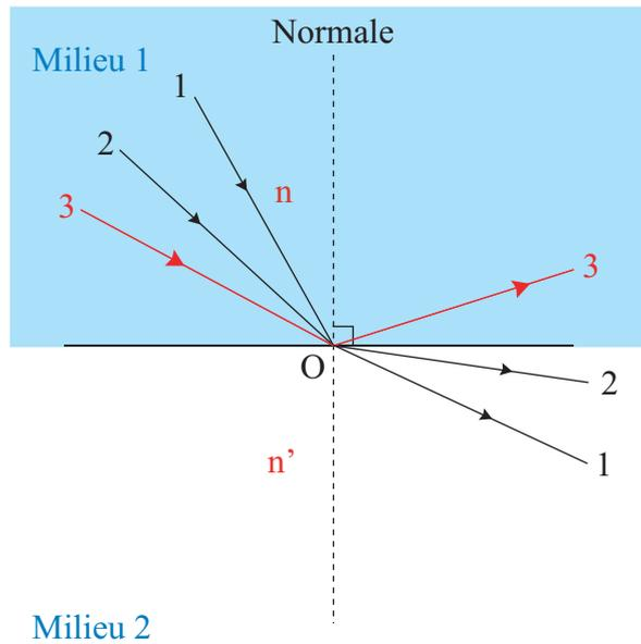
**FIGURE 1.7 :** *Le rayon incident est totalement réfléchi lorsque l'angle incident devient suffisamment élevé*
