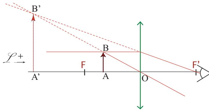
**FIGURE 1.16:** *Principe de construction de la loupe*
