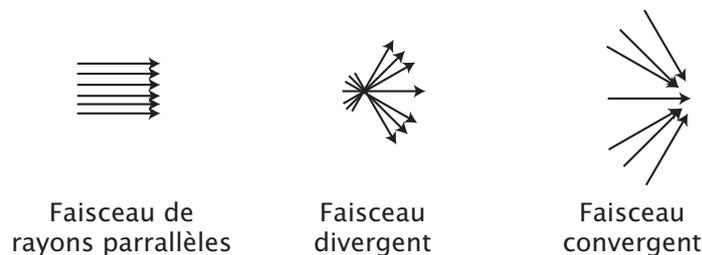
**FIGURE 1.2:** Différentes allures de faisceaux
