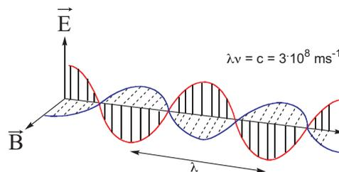
**FIGURE 1.1:** Représentation vectorielle d'une onde électromagnétique
