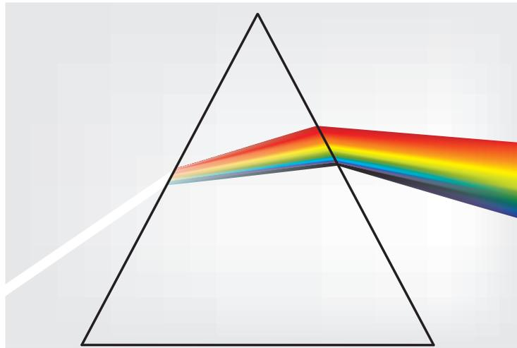
**FIGURE 1.10:** *Dispersion de la lumière à travers un prisme*
