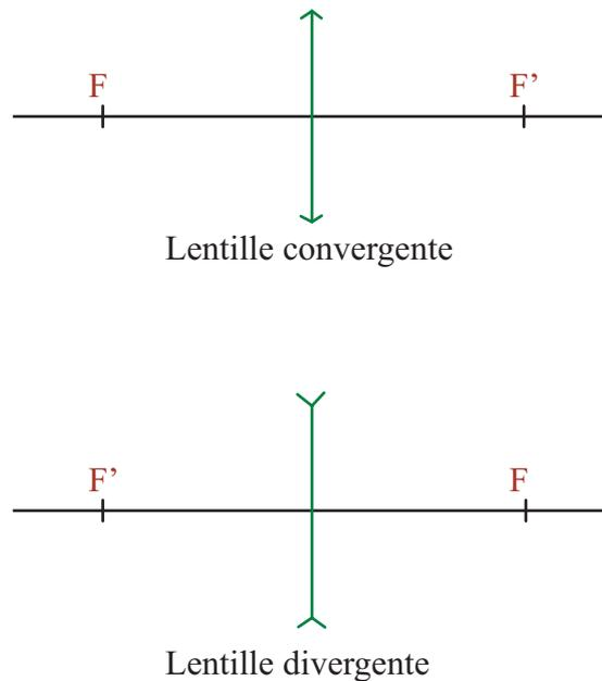
**FIGURE 1.13:** Schématisation des lentilles convergentes et divergentes
