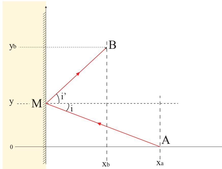
**FIGURE 1.3 :** La lumière se propage du point A vers le point B en se réfléchissant sur un miroir plan.
