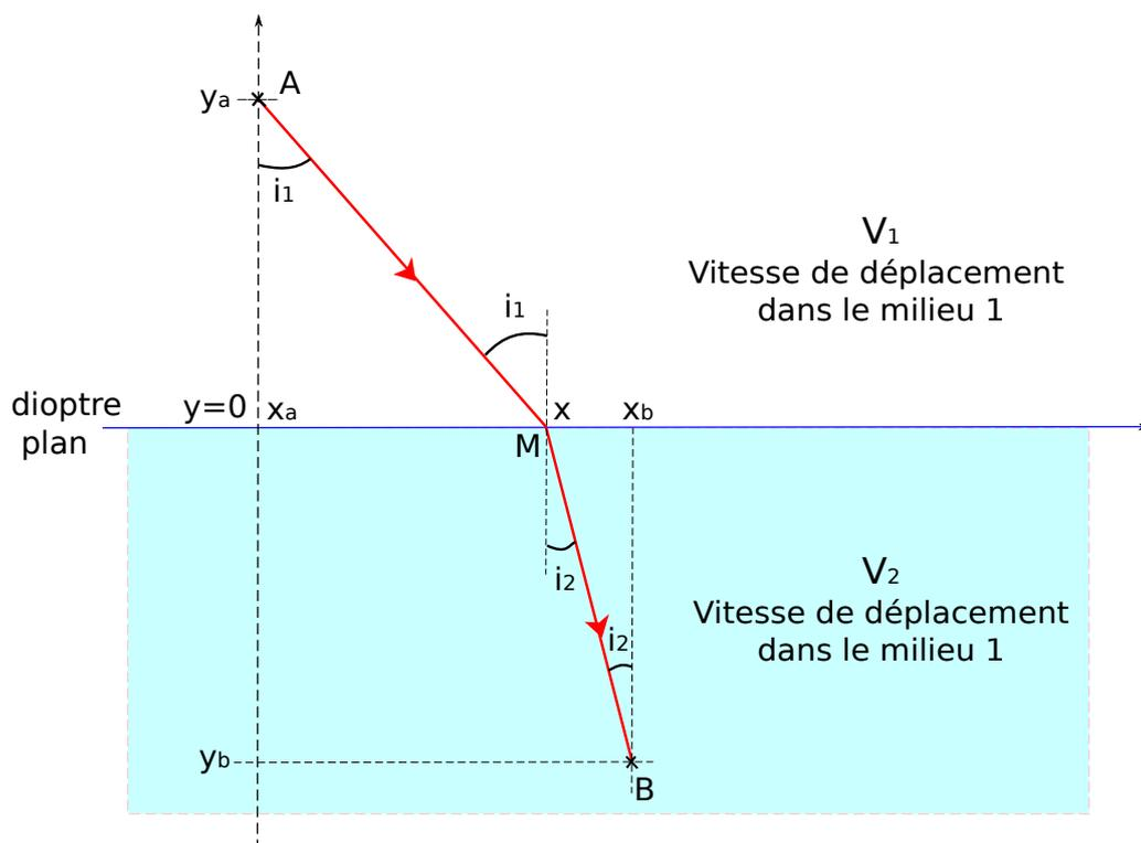
**FIGURE 1.4 :** La lumière se propage du point A vers le point B en subissant une réfraction en passant du milieu 1 vers le milieu 2
