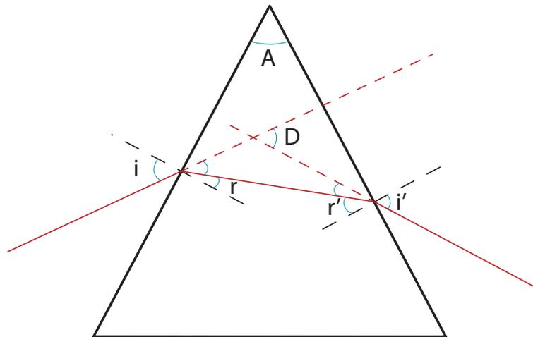
**FIGURE 1.9 :** Représentation de la marche d'un rayon lumineux dans un prisme et définition des différents angles formés.
